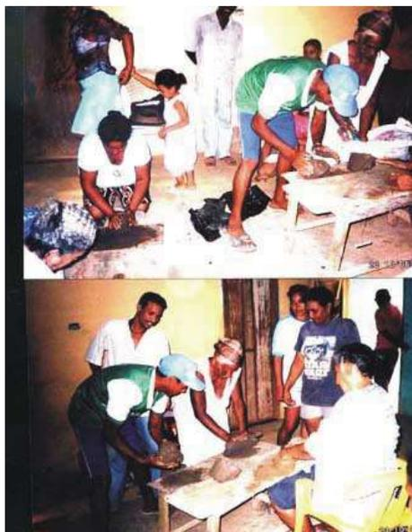
Tabajo de taller; Proceso de amasado y extracción del aire
