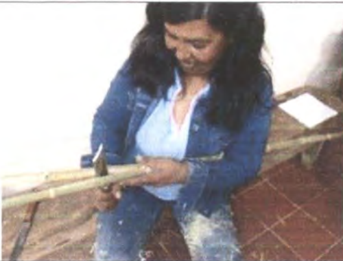
Abriendo el chin, utilizando palanca de la forma del cuchillo Tenza, Boyacá Foto: Silvana Navarro Artesanías de Colombia Noviembre de 2006
