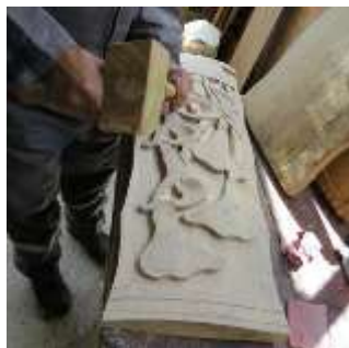
Proceso productivo Talla de madera , oficio Carpintería y Ebanistería. CRM,Facatativá, Cundinamarca, septiembre de 2015, Derly Giraldo, Artesanías de Colombia
