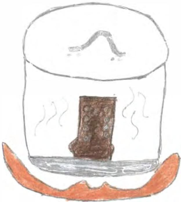
Colocamos el cilindro al baño maria , paso que demora 1 hora mediante este proceso de la cera va desapareciendo con el vapor . teniendo en cuenta que aquí la cera no desaparece total . esto termina de desaparecer en el horno
