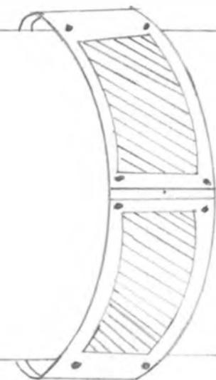
El trabajo que se esta realizando es un armado. Por lo tanto se hizo una lamina, para luego cortar 12 Placas de 40.4 Por 20mm con un grosor de 0.8 mm
