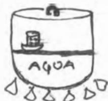
Colocamos el cilindro al baño maría para que demora 1 hora mediante el proceso la cera va desapareciendo con el vapor, teniendo en cuenta que aquí la cera no desaparece total;, esta desaparece en el horno.
