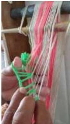
Para el siguiente paso, se retira la paleta y se hala la rulia de orillo a orillo, operación que permite desplazar los hilos hacia adelante, abriendo el cruce, que la tejedora separa con los dedos.
