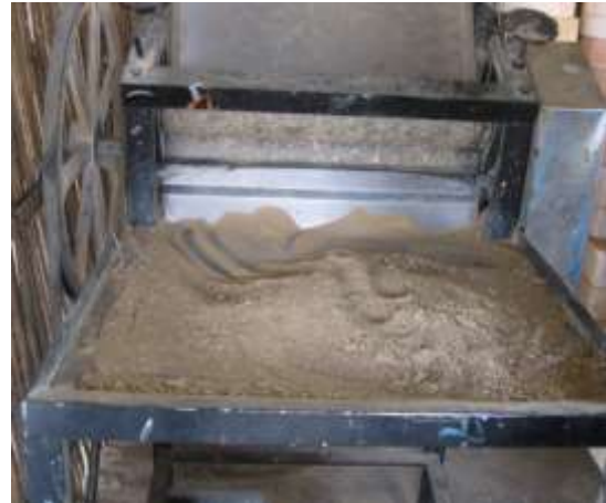
Maquina trituradora para procesar la materia prima Uribia. Junio 2016- Fotografía Marta Ramírez Fundación Cerrejón Guajira Indígena- Artesanías de Colombia
