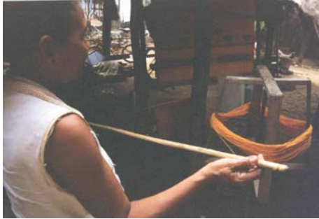
Proceso de encañelar la lanzadera
