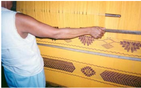
Proceso de tejeduría, paso de la paleta
