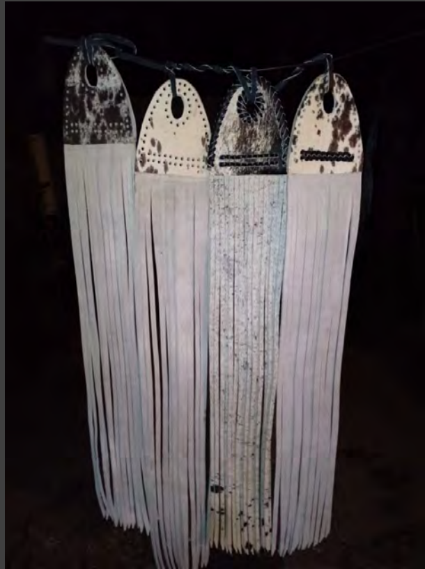
Etapa del proceso: ELABORACIÓN Y COSIDO DE LA CABUYERA Descripción: Cosido a mano de la Cabuyera, refuerzo de la estructura de donde se sostiene el cuero.
