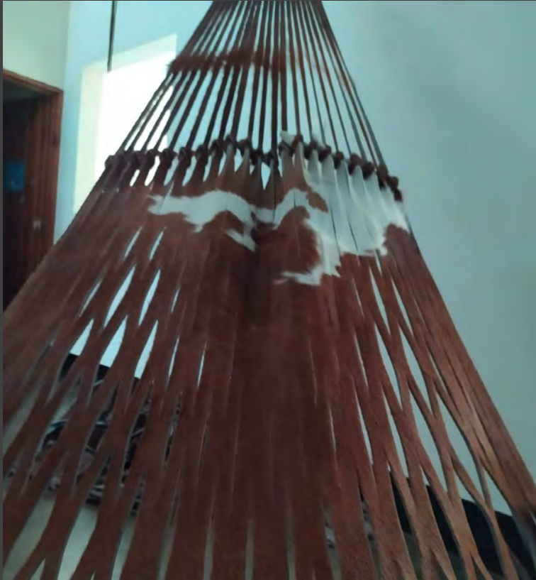
Etapa del proceso: CORTE Y CALADO DE LA CAMPECHANA Descripción: Verificación de los cortes realizados en el cuero .
