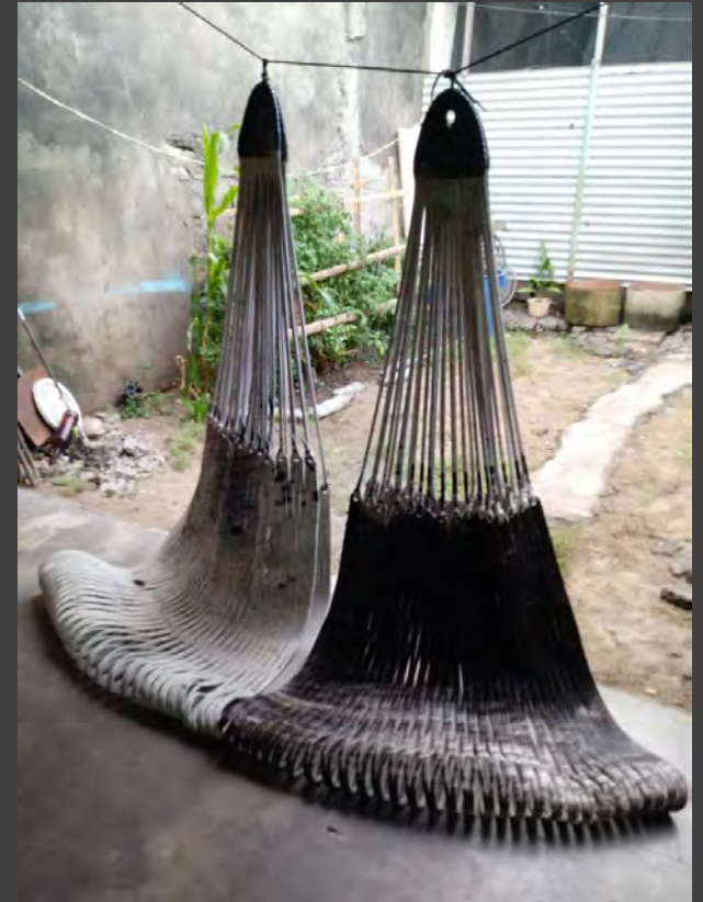
Etapa del proceso: FINALIZACIÓN DE LA CAMPECHANA Descripción: Verificación total de la campechana, desde la Cabuyera y su resistencia hasta los cortes intercalados del cuero.
