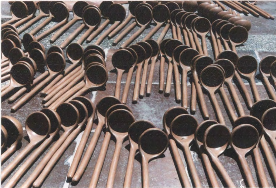
Bandejas y cucharones precalentándose al sol antes de ser horneadas
