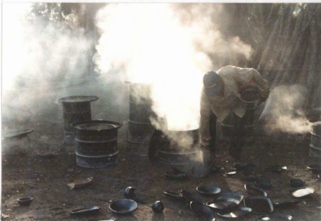
El negreado de las piezas se realiza en canecas y “moyos” poco refractarios, sometiéndolas a un proceso de reducción
