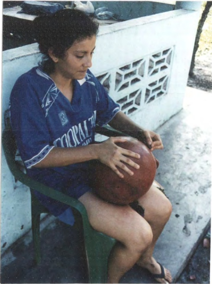
Se diseñaron bruñidoras en resina poliéster y nuevas espátulas ergonómicas para hacer más eficiente los acabados
