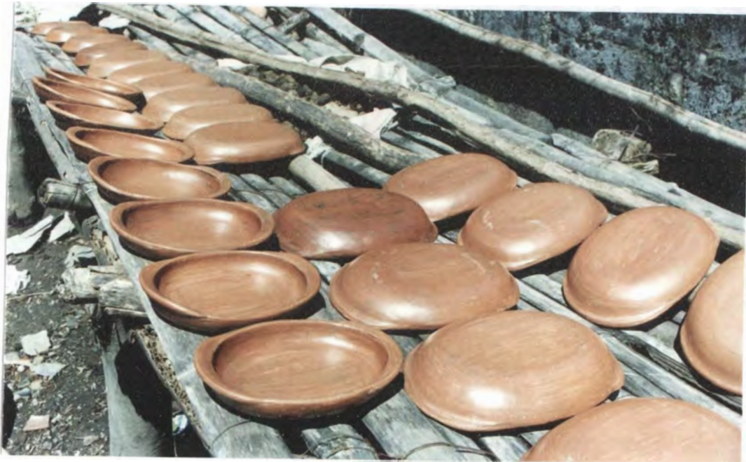
Las piezas son precalentadas al sol antes de la cocción
