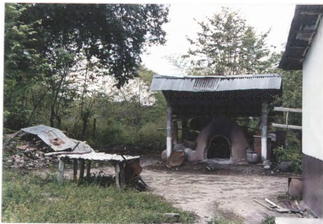
La “loza” se cocina en hornos tradicionales de bahareque, con leña, cuyas temperaturas no sobrepasan los 850°C
