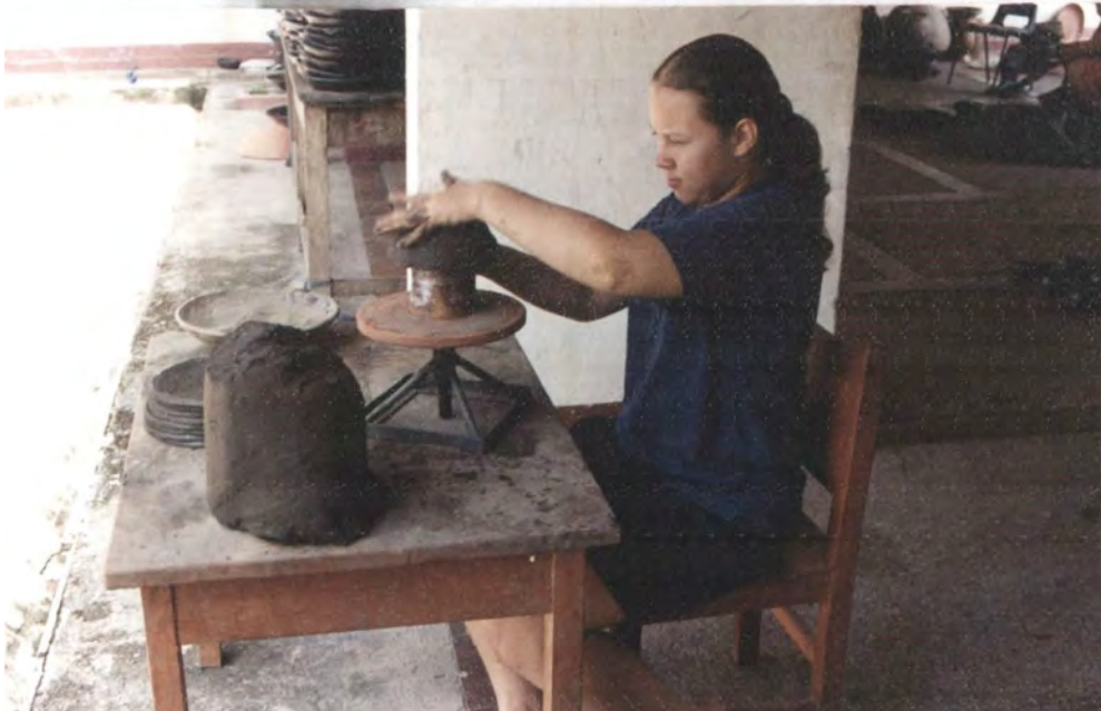
Las nuevas técnicas de moldeo con puestos de trabajo ergonómicos y tornetas mejoraron la salud de las moldeadoras y la eficiencia en el moldeo
