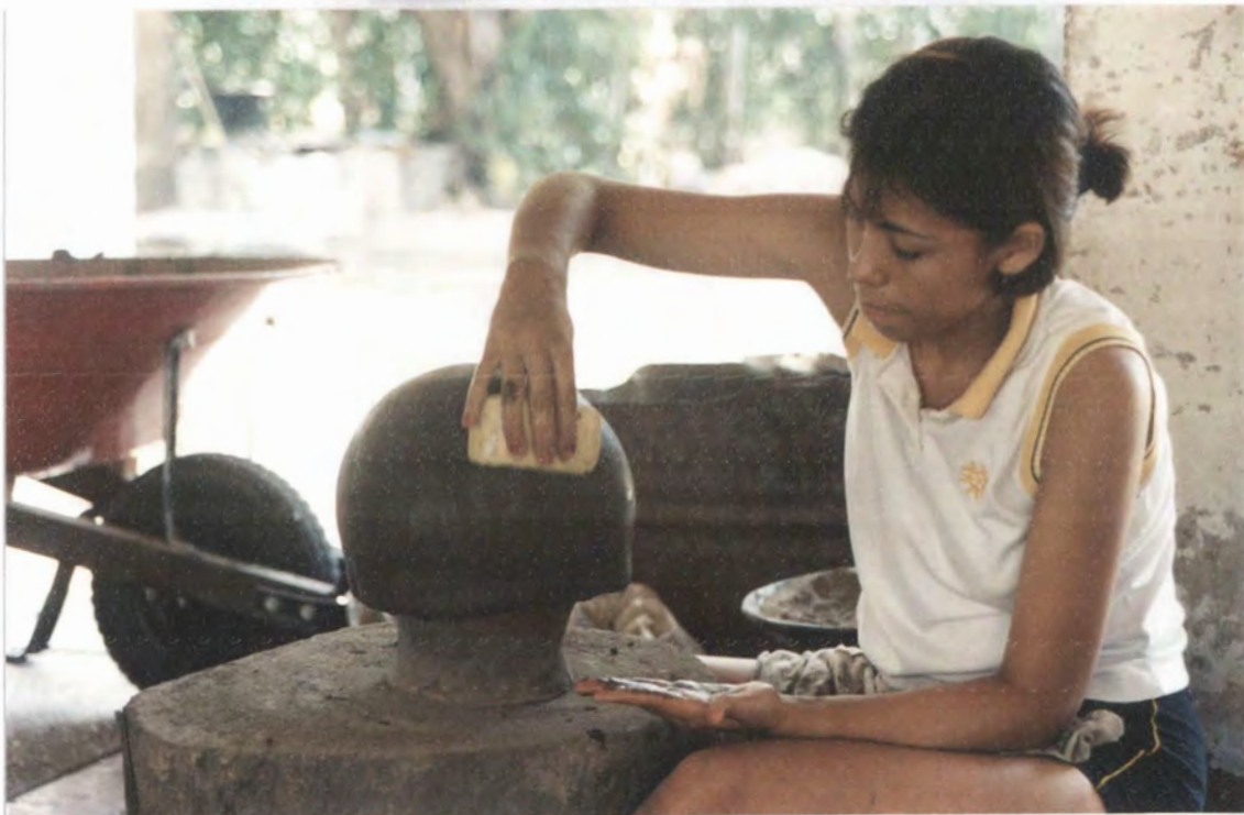
Con la “arepa” se moldea a presión, con las manos, sobre un molde o “guía”, cuyo tamaño difiere de taller en taller
