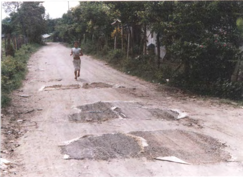
Dos sistemas tradicionales e ineficientes de molido: el pilón de madera y los carros que pisan la arcilla extendida sobre la vía.
