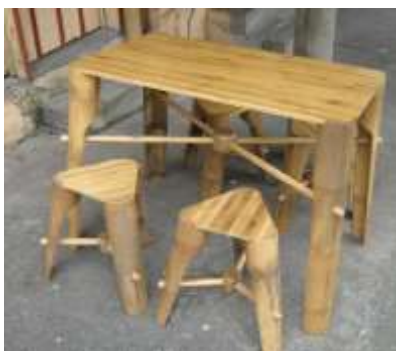
Molinari Comedor auxiliar. Diseño que combina la guadua laminada con la guadua rolliza en una estructura muy resistente.
