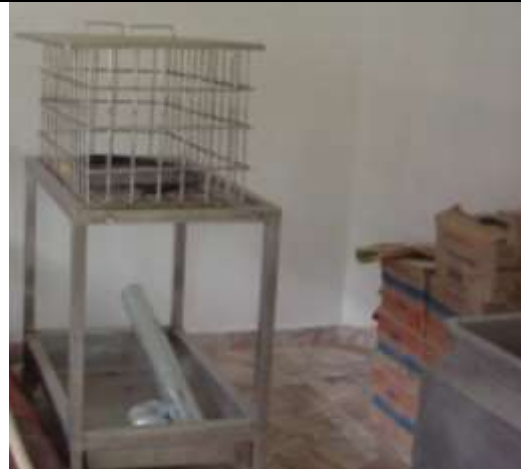
Foto: JHON AGUASACO Artesanías de Colombia Usiacuri - Atlántico Centro de tintura Canastilla para escurrido y transporte de fibra Demasiado pesada para la labor. Noviembre de 2007
