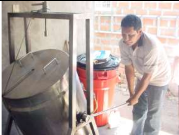
Foto: JHON AGUASACO Artesanías de Colombia Valledupar Cesar Centro de tintura Reubicación de la palanca de volteo de la marmita realizada en la visita Diciembre de 2007
