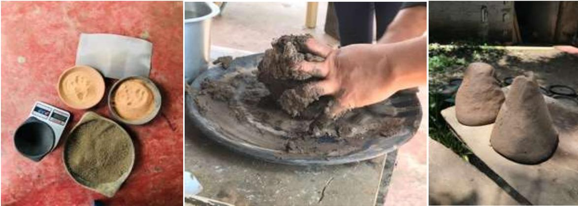
Mezclado de componentes en seco y preparación de la *pella*
