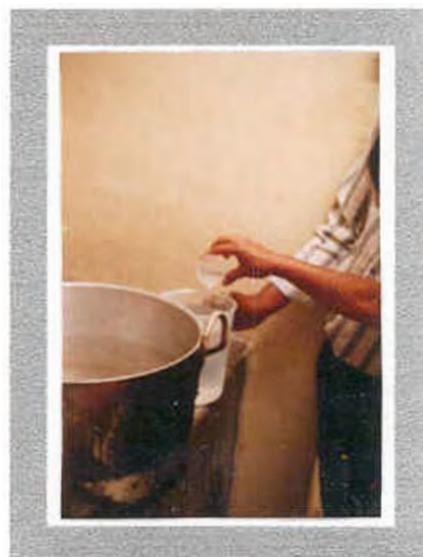
Después se introduce la fibra y se deja a una temperatura de 70 C durante 20 minutos. Se debe menear constantemente.
