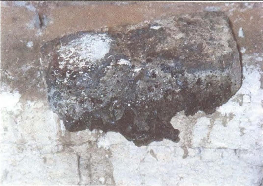
Ladrillo extraído de la cámara de combustión de un horno de carbón coke
