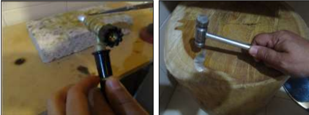
Recido, martillado sobre tronco y martillo de formas
