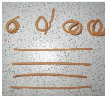
Prueba de rollo cocción a 1050° c
