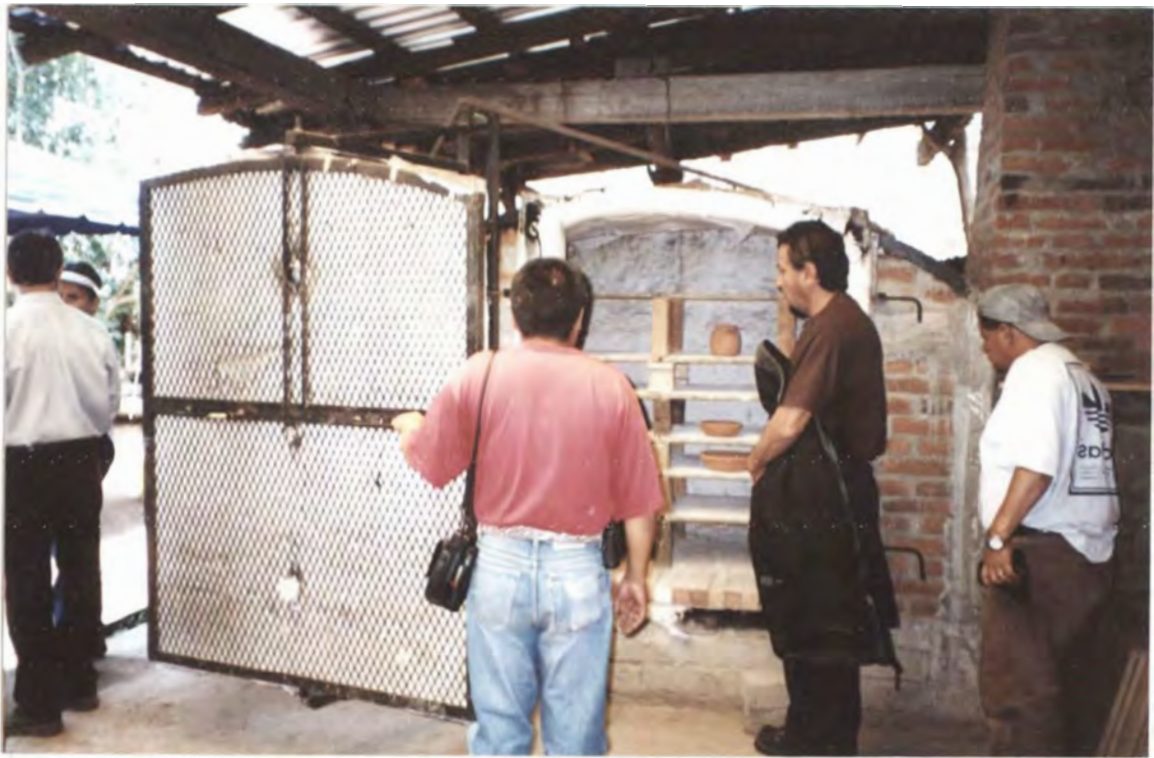
FIGURA 14-A Horno de leña de tiro invertido. Frente.
