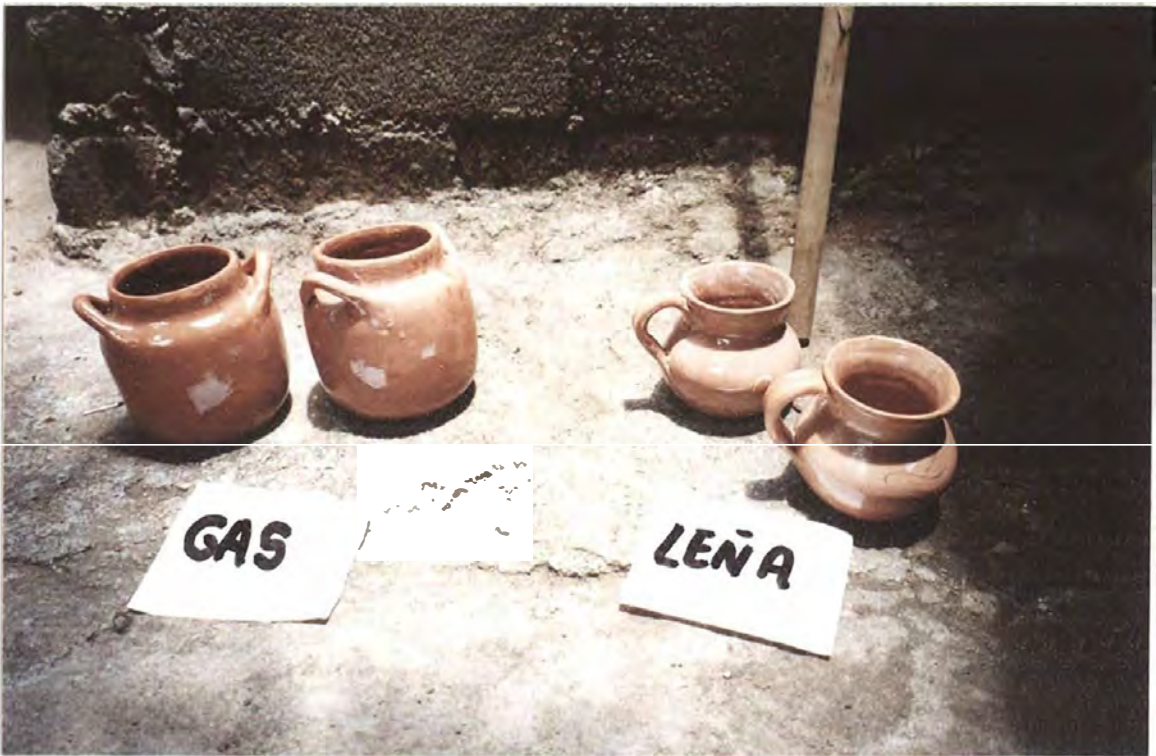
FIGURA 8-A Piezas esmaltadas con esmalte transparente. Quemadas en horno de gas y de leña.
