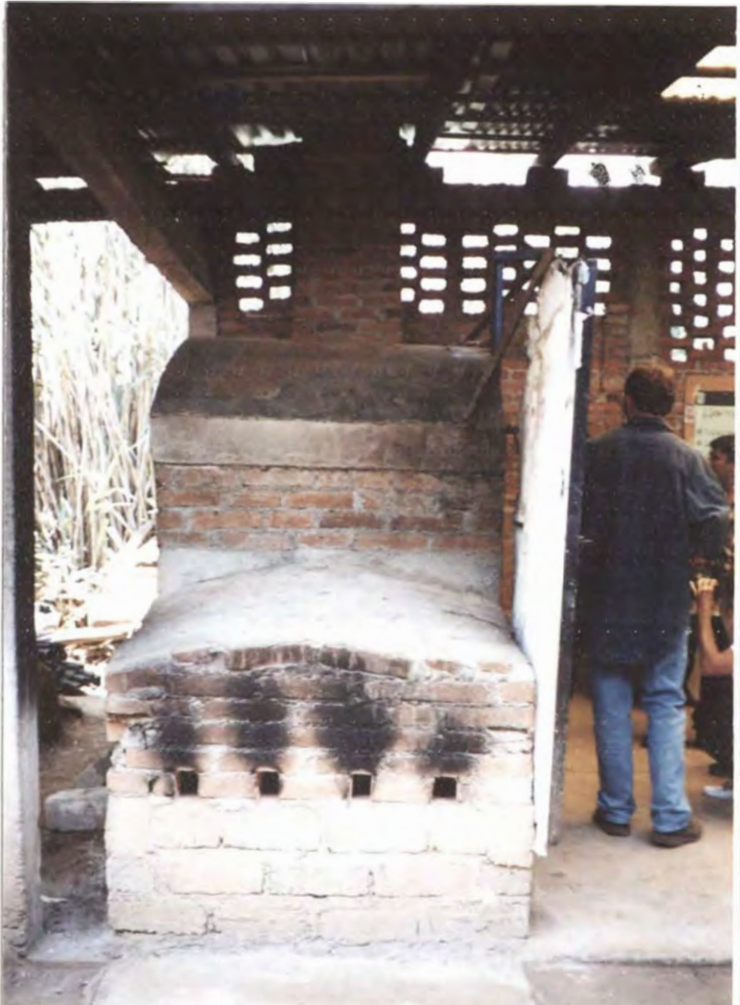
Figura 14-E Horno de leña de tiro invertido. Hogar lado.
