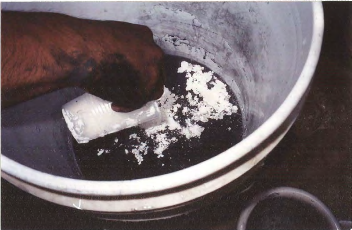
FIGURA 4-B Esmalte transparente disuelto con el oxido colorante.
