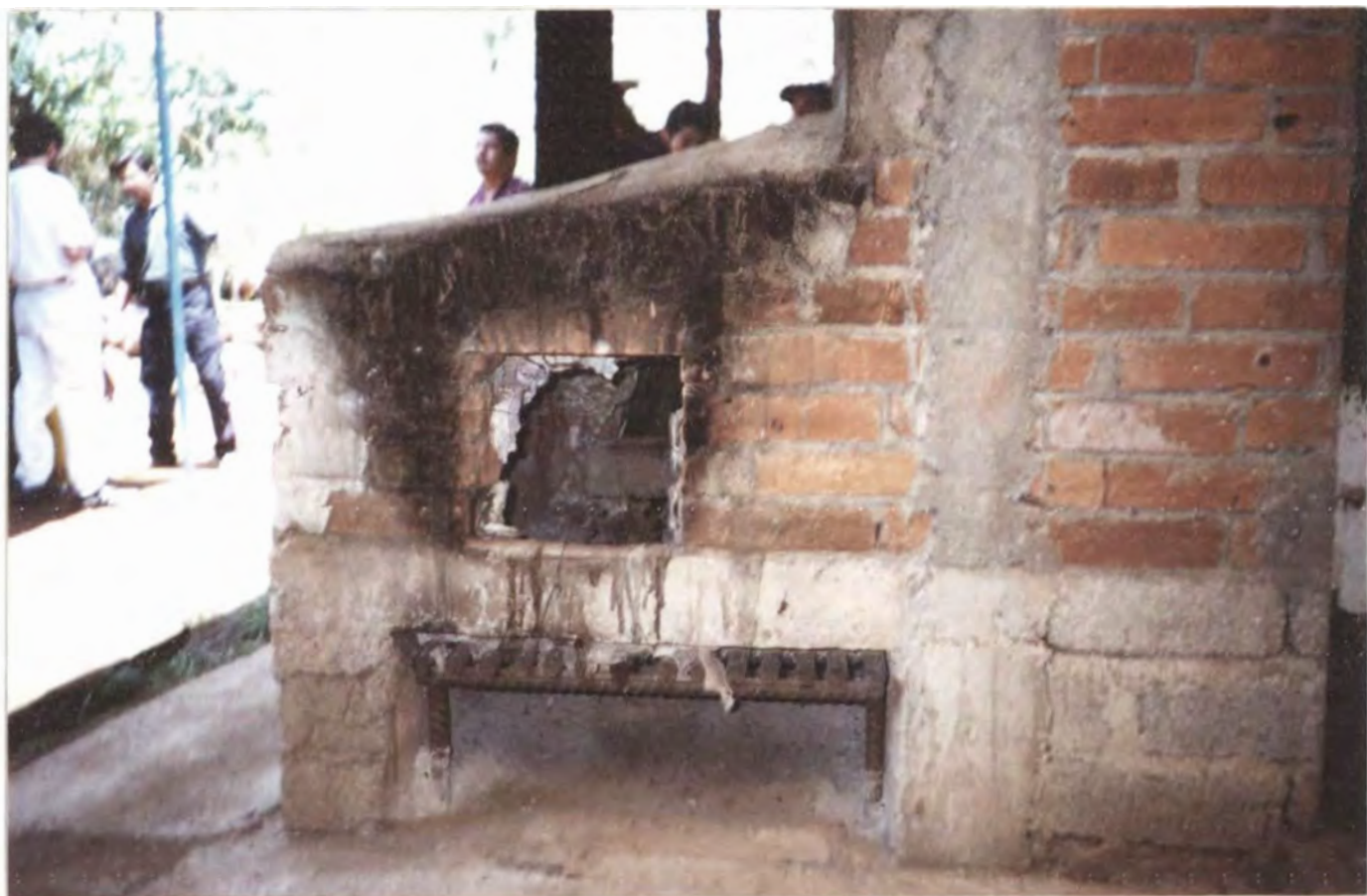
FIGURA14-C Horno de leña de tiro invertido. Hogar frente.
