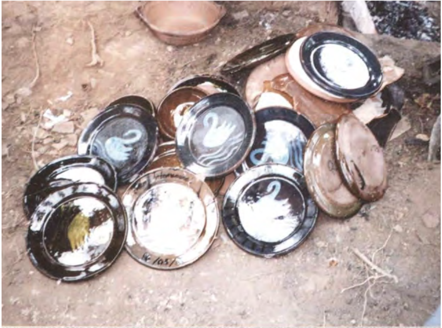
FIGURA 9-A Resultados de esmalte transparente con oxido colorante quemados en horno de leña.
