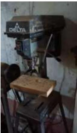
Máquina herramienta usada para realizar perforaciones en la madera, la herramienta de corte son las brocas y estas varían de diámetro controlando su profundidad.
