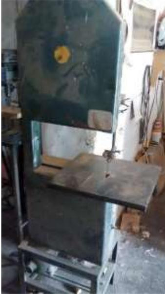
Está compuesta por una cinta circular, herramienta de corte que tiene uno de sus filos dentados, gira sobre dos ruedas volantes que le permiten hacer un proceso de corte continuo, para lo cual se cuenta con una mesa de hierro. Es usada principalmente para cortes curvos o cortes en aserraderos.
