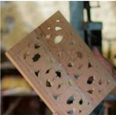
Tradicionalmente realizado con caladoras de mano, hoy se ha tecnificado la práctica con la implementación de caladoras de pelo que agilizan el proceso el cual consiste en realizar distintos cortes sobre una superficie creando vacíos que juegan y hacen parte del diseño.
