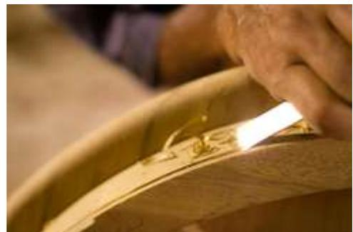
Teniendo el producto ensamblado, se realizan resanes, se emparejan los ensambles y se empieza un proceso largo de lijado, el cual le da la estética al producto terminado. A continuación se procede a darle una primera capa de tinte haciendo una combinación entre anilina, agua e inmunizante que se aplica a mano. Después de secado se da la primer lijada y de ser necesario se aplica una segunda capa de tinte.
