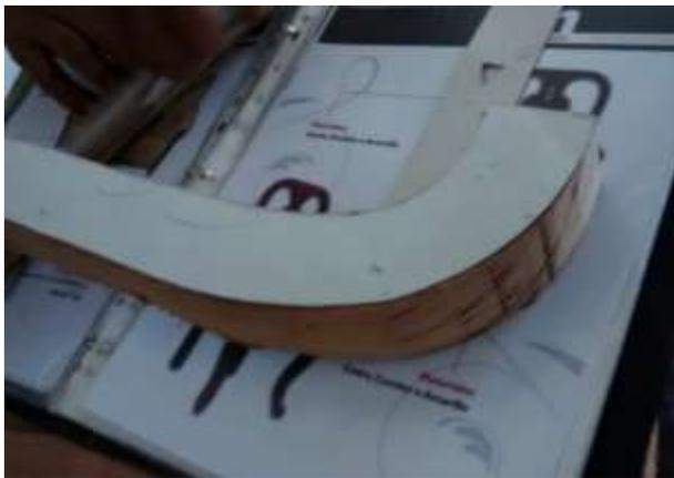
Usando plantillas de acuerdo al diseño y sus dimensiones, se marca sobre las pizas dimensionadas: ensambles, perforaciones y cortes.
