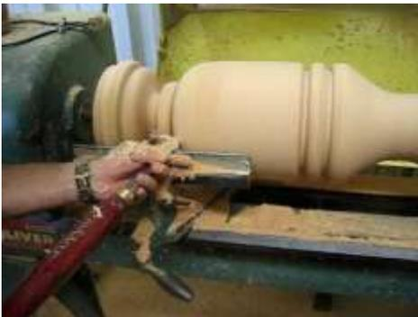
Piezas que se construyen a partir del giro sobre su propio eje que permite el labrado con formones de una geometría revolucionada.
