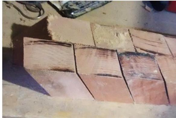
**Ensamblado y Prensado:** Estos romboides se distribuyen en 10 filas, las cuales se entrecruzan como una pared de ladrillos intercalando las direcciones del módulo para darle mayor estructura a la pieza. Asegurándola con prensas y retazos de neumático que mantienen una presión constante para que el pegante haga su trabajo. Tiempo 6 horas
