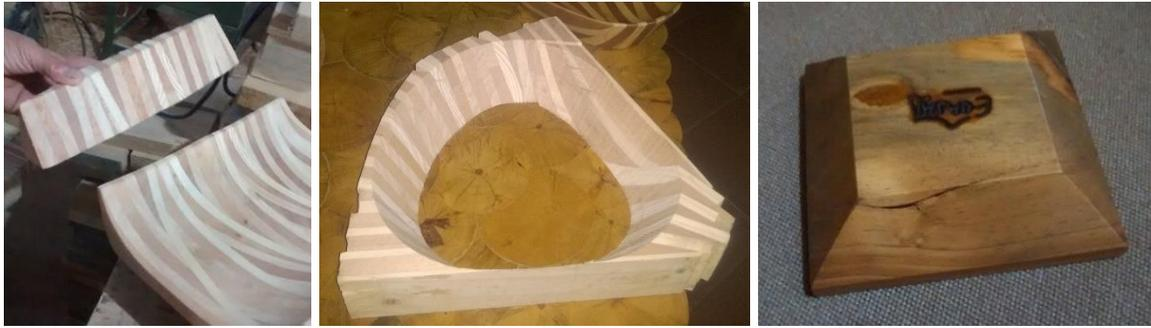
**Lijado de Perfiles:** Se usa lijadora de banda para pulir perfiles cortados con la sierra Sinfín y algunos filos. Tiempo 20 minutos
