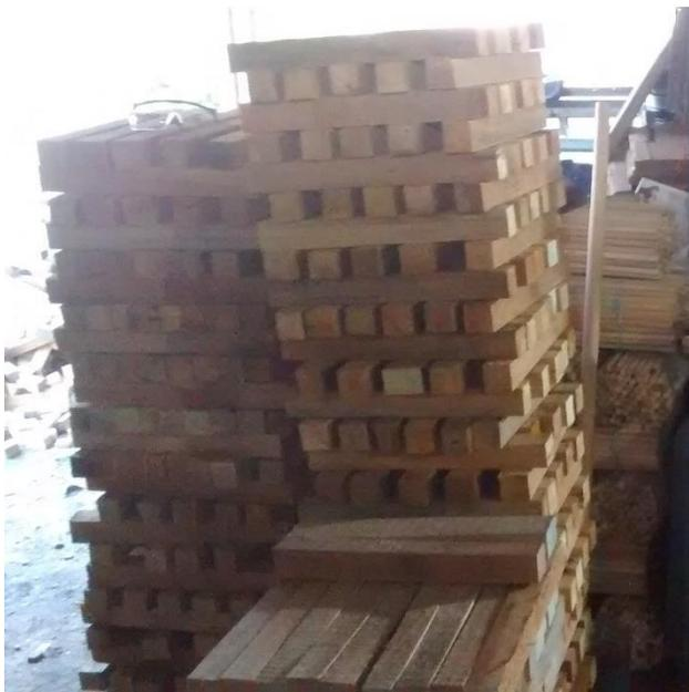
Para la construcción de tableros, se manejan listones o laminas que van de 1cm a 5cm de espesor, largos de 30cm a 120cm y anchos de 3cm a 5cm. La construcción de Bloques también puede realizarse a partir de listones o laminas, pero también se aprovechan los desperdicios de los bloques y tableros ya prensados y procesados.
