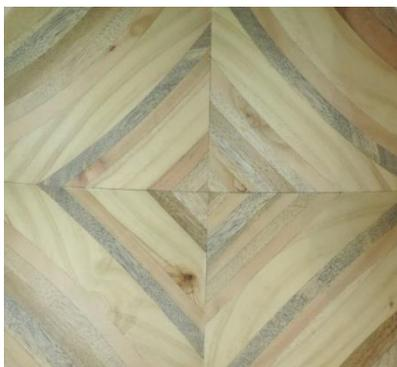
**Ensamblado Y Prensado:** Esta es una etapa muy importante principalmente para el diseño y textura visual de la pieza a partir de la configuración de las diferentes maderas, y ha sido uno de los enfoques en el proceso de diseño realizado con el artesano, trabajando principalmente con bloques construidos a partir de tabletas, ya que en estos se puede controlar y dibujar con la textura que se dará a la pieza.
