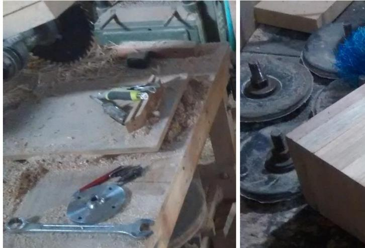
A la misma maquina se le adaptan discos de lijado (Construidos por el artesano) y se pule el vaciado que dará forma a la artesa, el artesano a construido 4 discos de lijado con una base de goma sobre a cual se colocan lijas de tela N° 60, 80, 120 y 150. Todo el proceso de vaciado y lijado se realiza en 1 hora y 15 minutos
