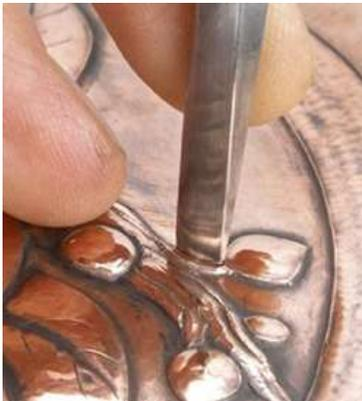
Técnica artesanal para realizar cortes, donde con la ayuda de un cincel, otros utensilios adaptados y martillo, se pueden crear cortes y repujado sobre láminas para obtener figuras orgánicas y detalles sobre las mismas.
