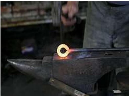
Es un gran bloque de hierro o acero, su forma y el acabado en ambos extremos en punta facilitan el proceso de forjado. Se usa como base para golpear el hierro y darle forma.
