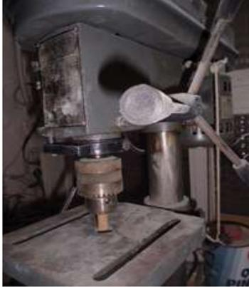
Es una máquina herramienta que tiene por función producir agujeros en una pieza cualquiera, se destaca por su fácil manejo y se usa en conjunto con brocas de diferente diámetro.
