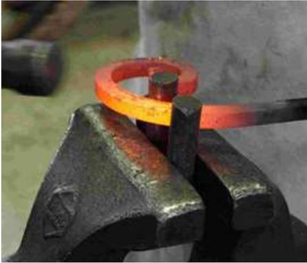
Para lograr el curvado de varilla de mayor grosor, estas se someten al calor en la fragua buscando darles maleabilidad; se usa la técnica del martilleo para ir dándole forma a la varilla, la cual puede ser introducida de nuevo al fuego para seguirla trabajando.
