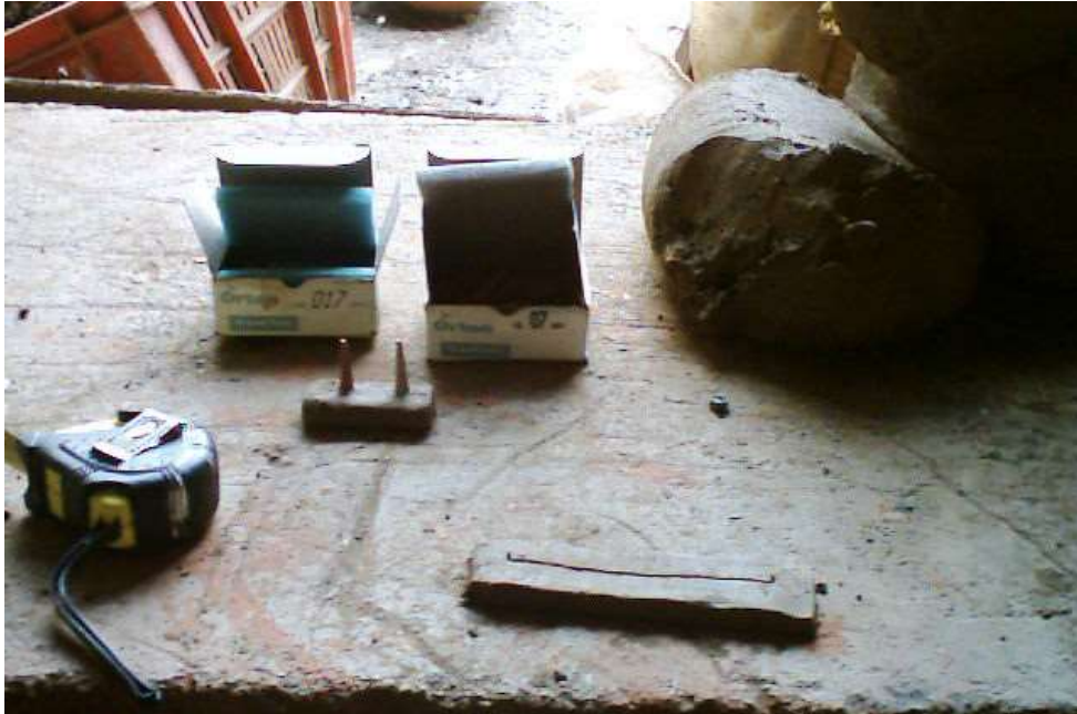
Preparación de dispositivos para medir temperatura y contracción de la arcilla Artesanías de Colombia 2006.
