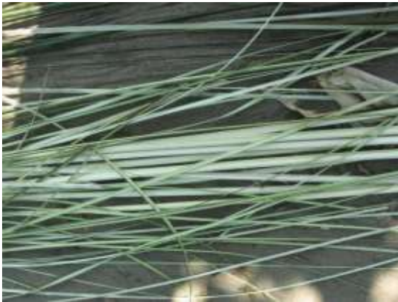
Materia prima mal cortada: anchos desiguales y con residuos de médula del tallo
