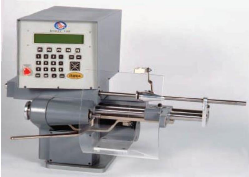
*Su función es preparar el hilo para realizar el tejido , el hilo simple se embobinan ovillos y a medida que se embobina se puede dársele más torsión o combinarse con otros hilos para fabricar un hilo de varios cabos.*
