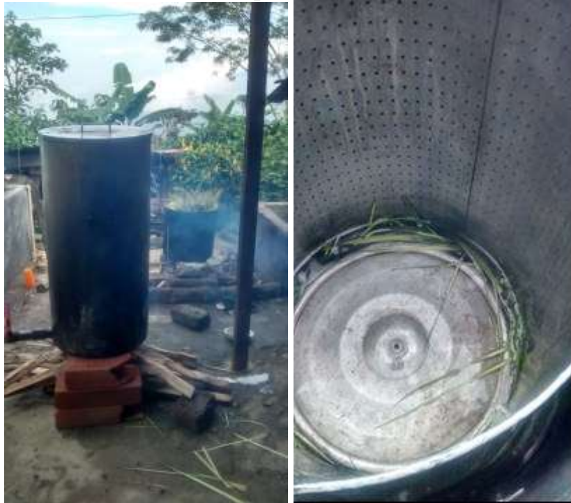
Tomada por: Jairo F Saavedra Pinzón Lugar: Aguadas, Caldas. Fecha: octubre de 2015 Descripción: Tanque con porta material en acero inox 304
