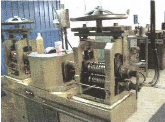
Fig.6. Laminadora y trefiladota. Mangueras de paso de agua para refrigeración.
