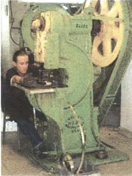
Fig. 12. Troqueladora de corte y estampado simultáneos.
