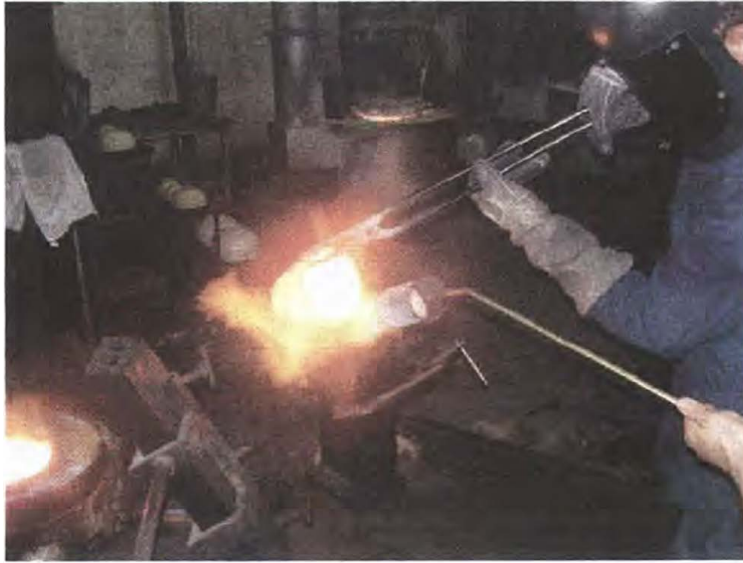
Fig. 3. Vaciado del metal acompañado con soplete con llama antioxidante.
