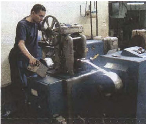
Fig.8. Laminadora con carretes para control de tensión.
