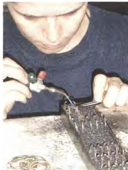
Fig. 17. Soldadura de caps de las candongas. Llama puntual.
