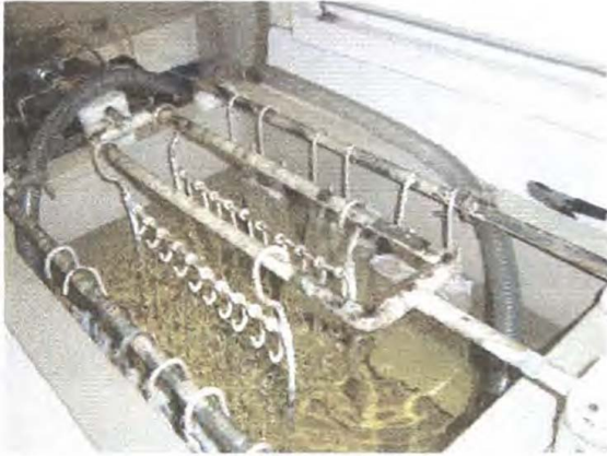
Fig. 28. Piezas en baño de plata.
