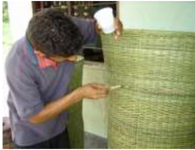
Retoques de espacios internos del bejuco donde no penetró el colorante
