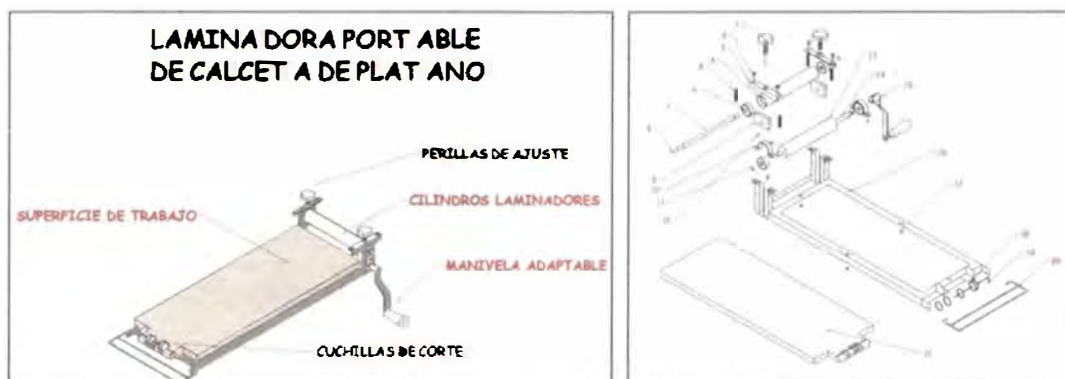
Unidad de diseño 2006 – Diagrama Laminador portable – D.I Manuel Abella
