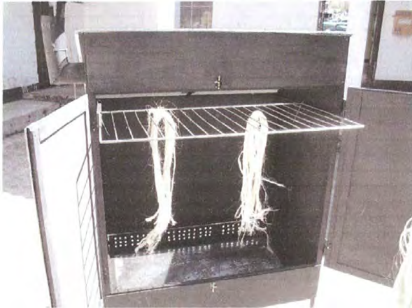
Sistema retráctil de parrilla y puertas de acceso de fácil manipulación .
