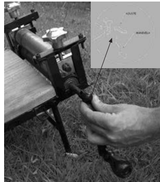
Unidad de diseño 2006 - Laminador portable manivela / Diagrama – D.I Manuel Abella
