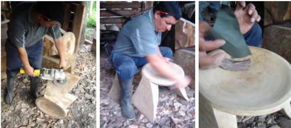
Pulidora de trabajo mediano Pulido a mano mediante lija de agua y proceso de lijado en la fabricación de un banco tradicional.
