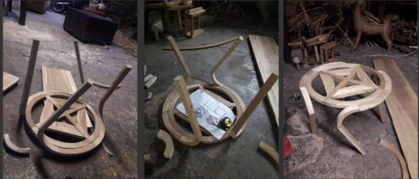
➔ Muestras de la estructura de la mesa ya con las patas ensambladas.
