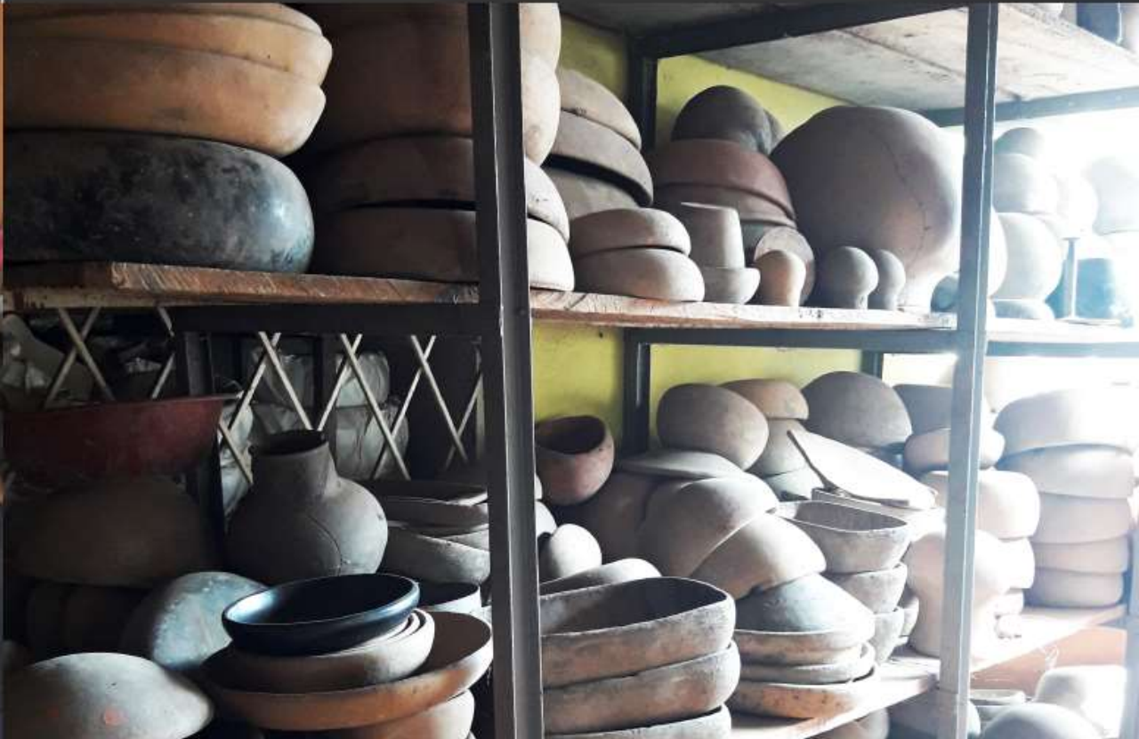
Matríz, las cuales usan a modo de molde para realizar producción en serie. ↘
