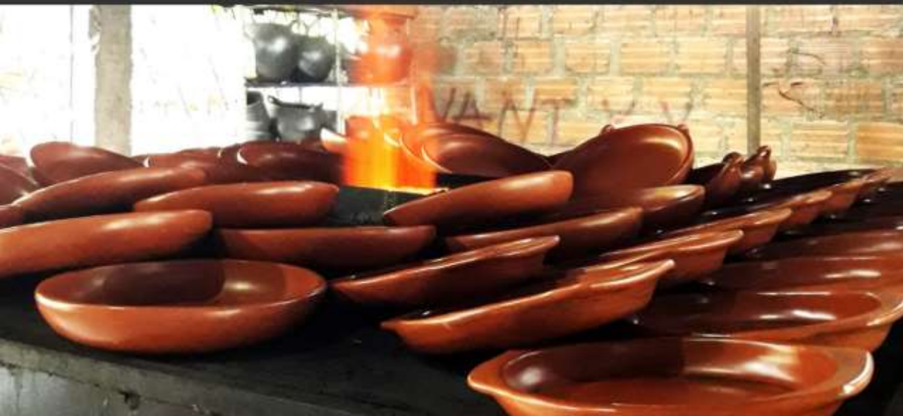
Quema y secado de piezas en el horno a gas. ↙
