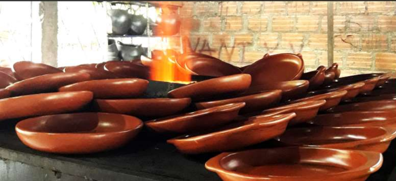
Quema y secado de piezas en el horno a gas ↙
