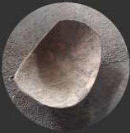
- "Cucharas" tradicionales de totumo, son menos durables. Se usan para alisar y dar forma a las piezas
