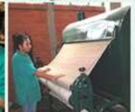
A través de la calandra (máquina engomadora), se impregna con calor un P.V.H. que le da consistencia y planchado a la tela. (Este proceso para elaboración de telas)
