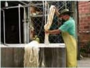
Consiste en aplicar color a la fibra, con un tinte especial para fique, se deja en remojo la fibra, se lava con agua y jabón, luego en agua caliente se aplica la tñtura, los mordientes o fijadores, el suavizante y se deja hervir, para que la fibra absorba el color. Después se lava con abundante agua y se extiende
