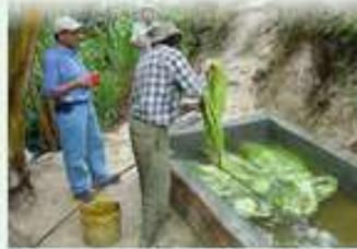
La cabuya desfibrada se sumerge en agua para retirar los residuos de hoja que debe hacerse en tanques, con el fin de evitar la contaminación de las aguas.
