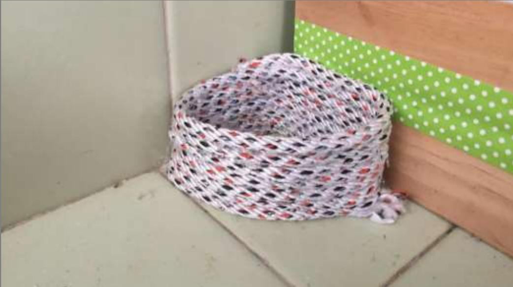
Modelo canasto en forma de esquina, escala 1:5 armado con cuerda de 6mm y silicona. Se simula un canato de 50cmx45cm
