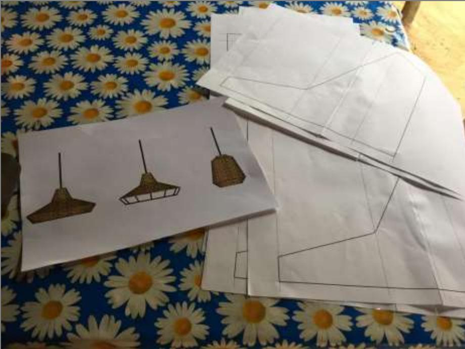
Se elaboraron plantillas con medidas reales a escala 1:1 para obtener matriz de la estructura en varilla, esto para garantizar la misma forma siempre
