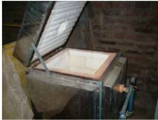
IMAGEN 7. Horno a gas para Cerámica. Municipio de Los Patios.
