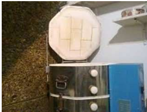
IMAGEN 4. Horno eléctrico para cerámico y detalle del portacono
