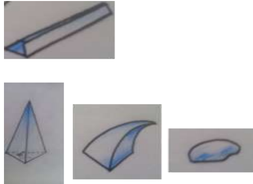
IMAGEN 5. Conos pirométricos para determinar la temperatura del horno y evolución de la quema. Dibujo Pedro López.
