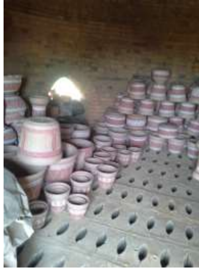
IMAGEN 3. Interior del horno dispuesto para quema. Municipio del Zulia.
