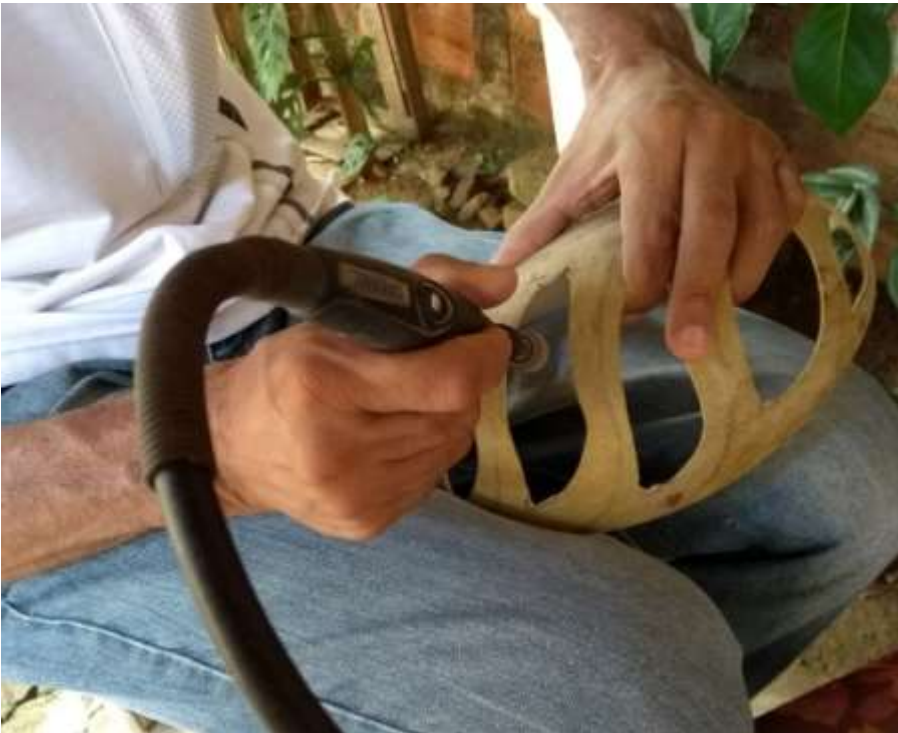
Proceso de calado con motortool
