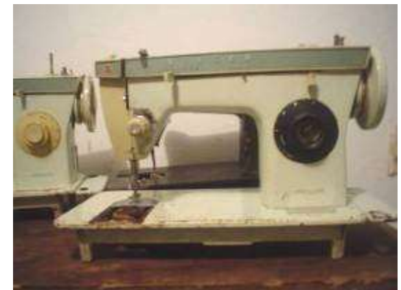
Limpieza y reparación. Le falta la planchuela, la caja bovina, la bovina.
