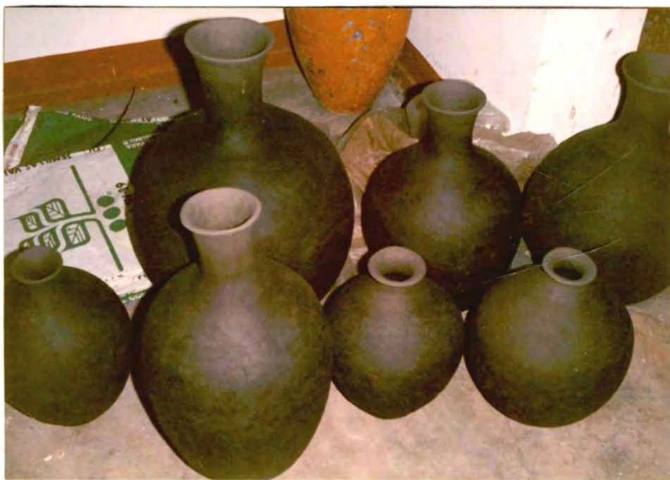
" SECADO DE LA PIEZA YA TERMINADA "
