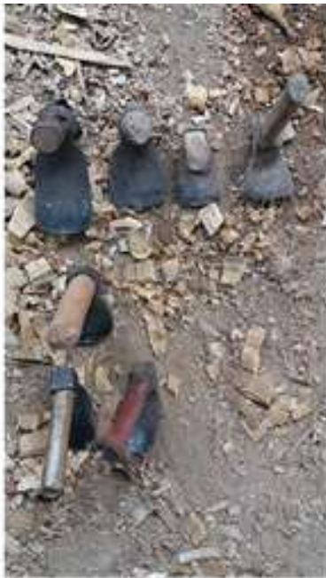
Arriba: Gubias de abrir Centro: Gubias de relimpia Abajo: Gubias de acabado.
