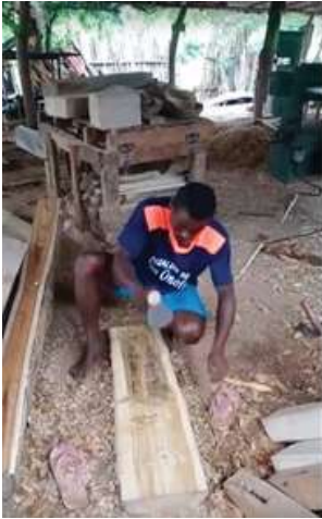
El empleo de gubias para abrir, relimpia y acabado se se realiza en el suelo.
