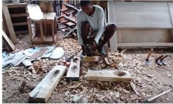
El empleo de gubias para abrir, relimpia y acabado se se realiza en el suelo.
