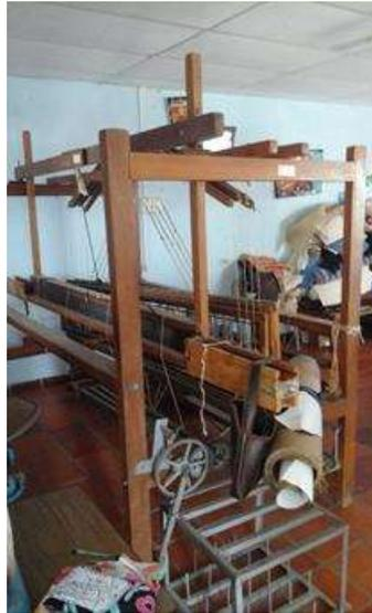
Se realiza sobre el mínimo que son 15 mts para realizar el montaje y luego se realizan los ajustes necesarios para sacar el producto hamaca. Varía la composición si tiene cenefa. Este proceso demora por mínimo 1 semana para montar 30 mts.
