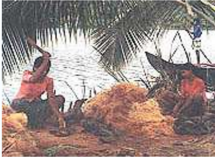
Las cáscaras provenientes de las albercas se golpean para separar las fibras (India) 7
