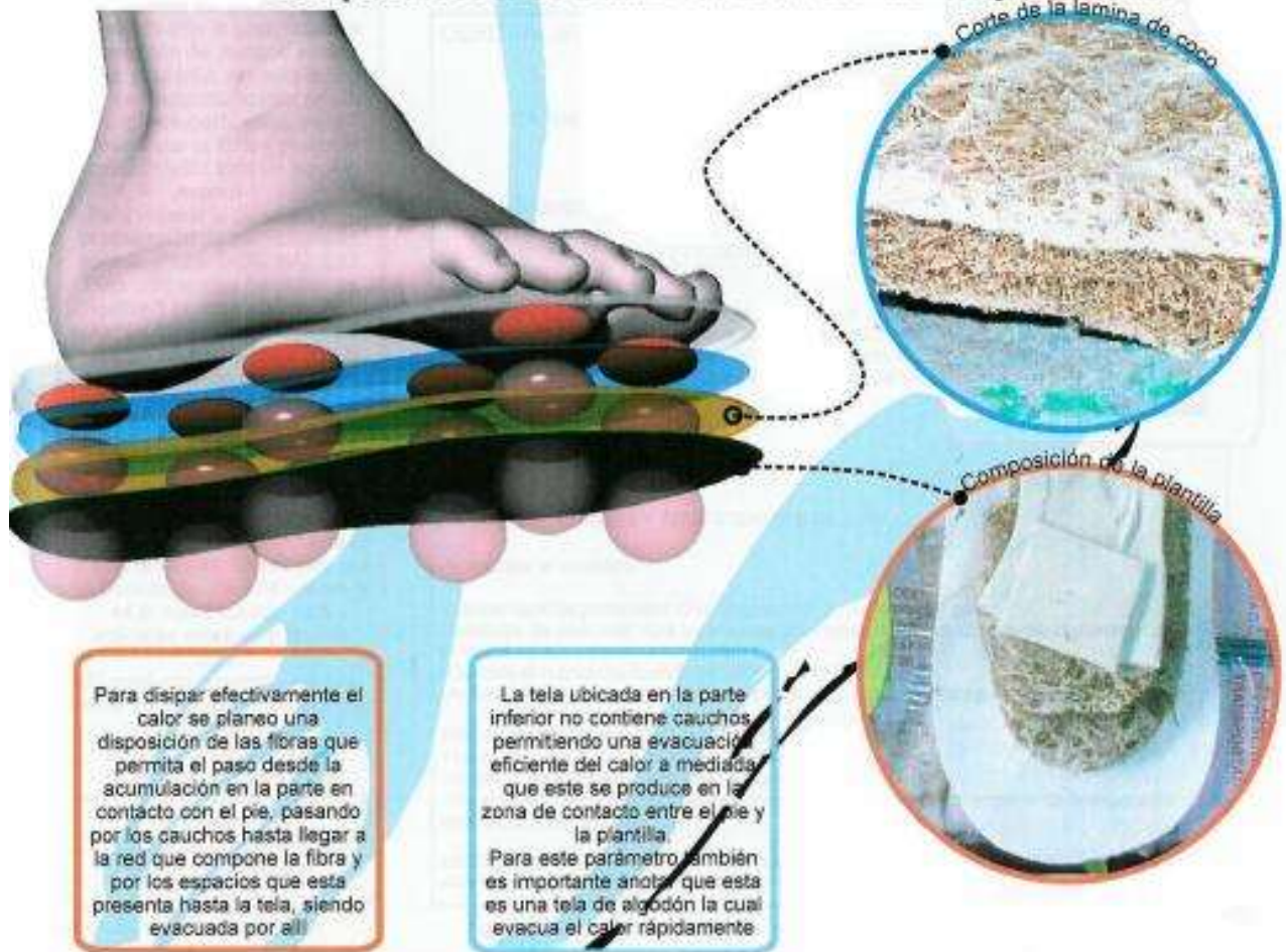
Foto 58. Visualización y descripción de la forma como el calor se disipa a través de la plantilla diseñada en fibra de coco. Tamayo 66 .
