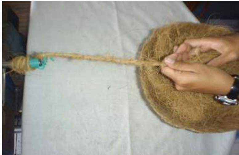
Foto 24. Hilado mediante un motor de baja velocidad. Deyanira Ariaz
