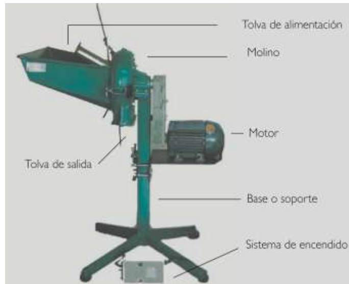
Foto 20. Molino de martillos-sierra. Deyanira Ariaz
