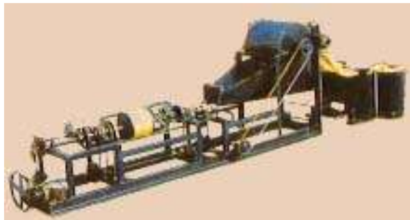
Foto 29. Hiladora eléctrica de fibra de coco 38
