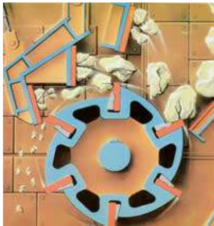
Foto 18. Mecanismo de una trituradora 27
