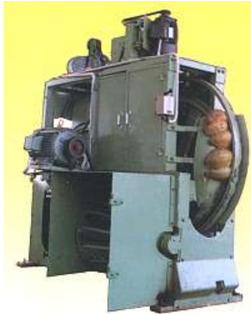
Foto 17. Desfibradora trituradora de coco (India) 26
