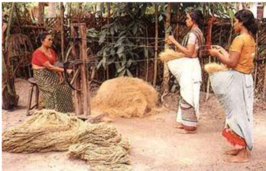
Foto 25. Hilado mediante rueca adaptada para 2 hilanderas (India) 35
