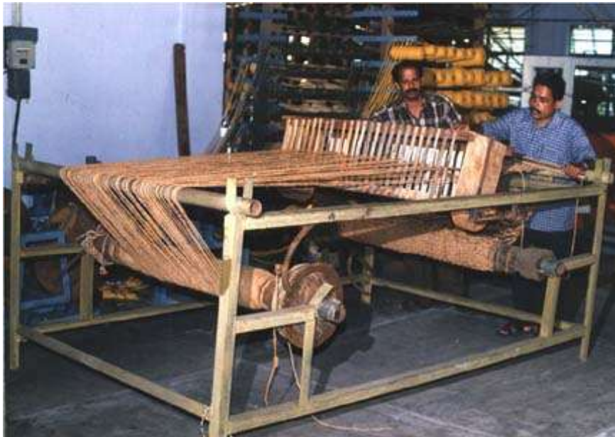
Foto 40. Tejido de tapetes en fibra de coco mediante telar manual horizontal (India) 50
