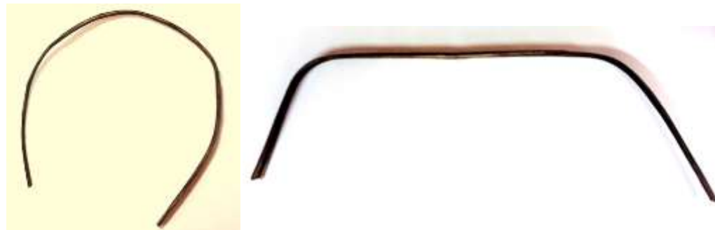
Piezas curvadas con molde circular y a 60°
