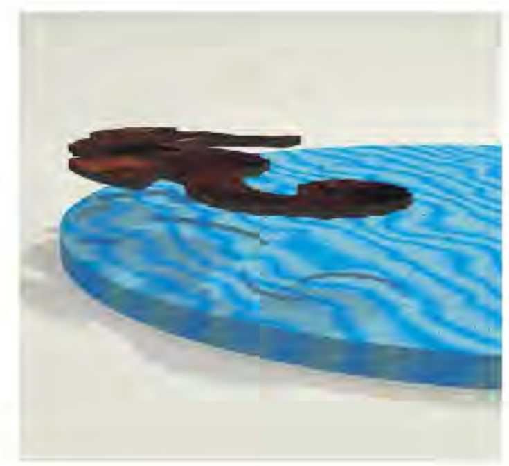
Ruteado de la figura en la madera para luego incrustar e enchape
