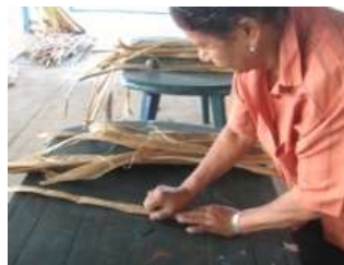
Laminado o aplanado de la calceta y corte de cintas para iniciar el tejido plano Fotos María Elena Uribe Vélez Artesanías de Colombia S.A.
