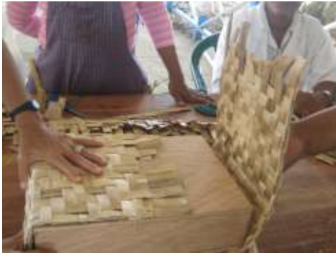
Unión de los extremos del tejido sobre el molde Fotos María Elena Uribe Vélez Artesanías de Colombia S.A
