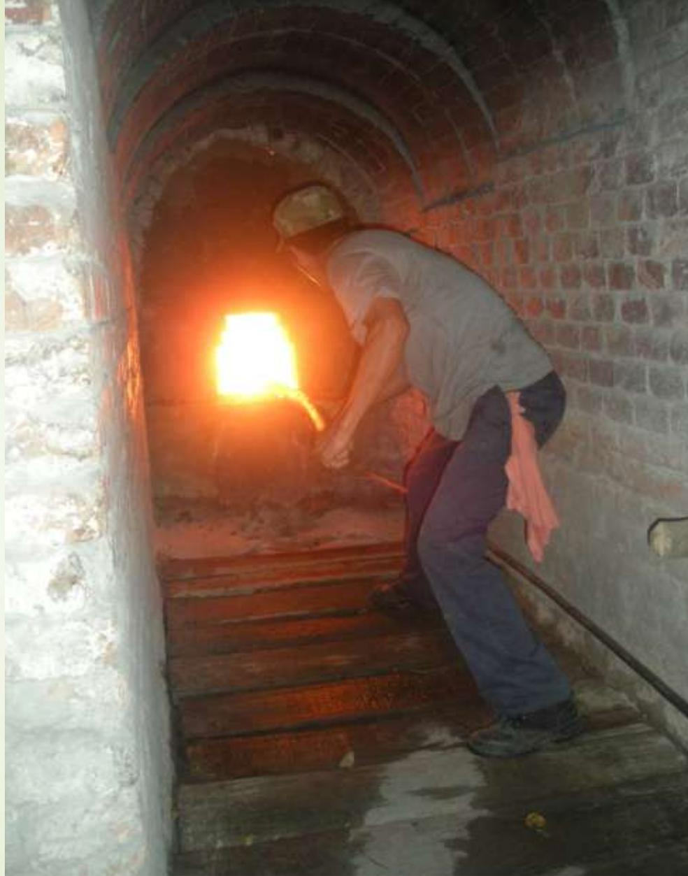
El "tubeado" del horno que se lleva a cabo después de ser cargado y tiene por fin avivar el fuego con lo que se intensifica la cocción y se eleva la temperatura
