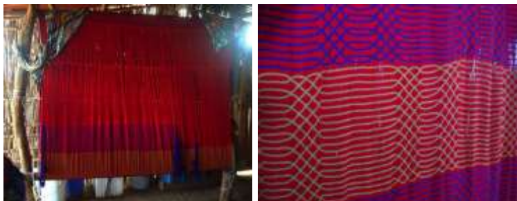
Chinchorro montado en telar de estacas - Chinchorro técnica de nudos
