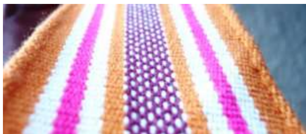
Cargadera de mochila a 1 hebra fabricada en telar.
