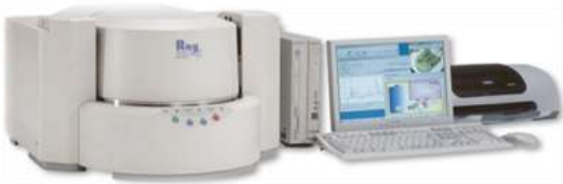
Espectrómetro de fluorescencia de rayos X por dispersión de energía (WDXRF). Shimadzu EDX-72
